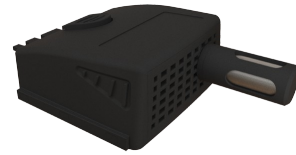
Module conditions climatiques (MCC) Gamme de mesure de 0 à +50°C, de 800 à 1100 hPa et de 5 à 95%HR
